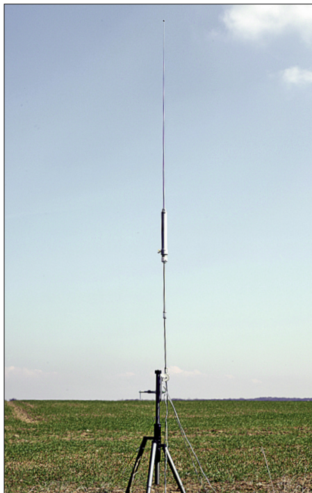
Bild 1: Portabelantenne für KW; HF-P1 auf einem Dreibeinstativ
