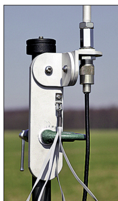
Bild 5: Montagewinkel mit Antenne, Koaxialkabel und vier Radialen
